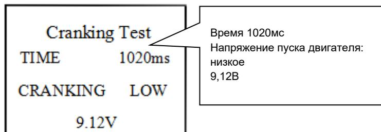
Это позволяет механикам быстро оценить состояние системы пуска двигателя. Если пуск двигателя не обнаружен, возможно, отсутствует выходное напряжение зарядки АКБ, необходимо проверить генератор.
