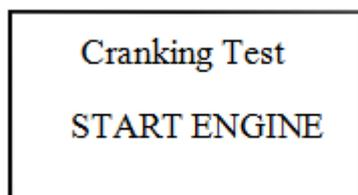
Выбрав вторую функцию тестирования, нажмите ОК. Включите двигатель, прибор автоматически производит тест системы стартерного пуска и отображает результаты испытания.
