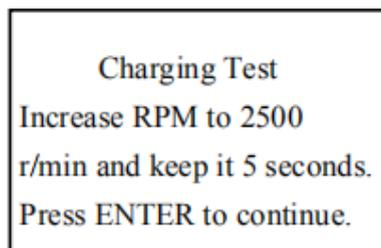
Прибор выполняет тест напряжения системы зарядки АКБ после увеличения оборотов двигателя.
